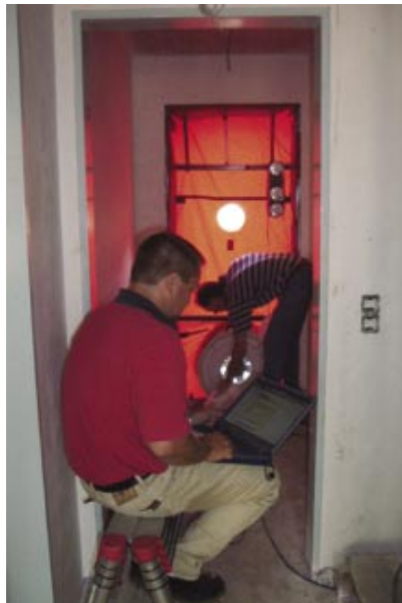
Blower-dDoor-Messungen ergaben auf Anhieb die Einhaltung der geforderten Luftdichtheit.
