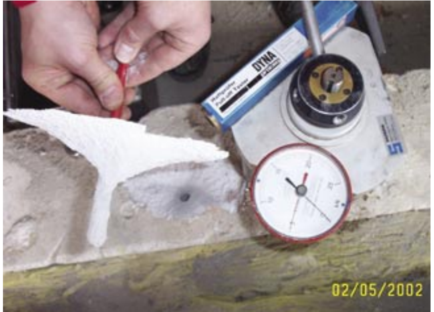
Ausreißtest für einen Injektionsanker für die Fenstermontage
